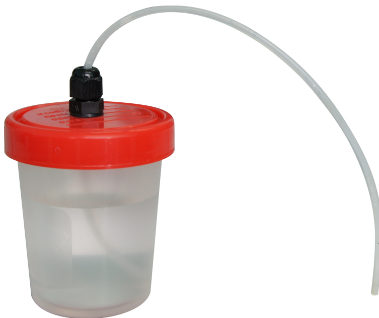
Рисунок 10 – Стакан с титрантом и трубкой
